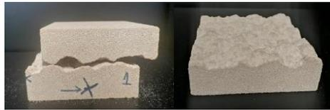
Figure 5. Echantillon de cisaillement imprimé en 3D
