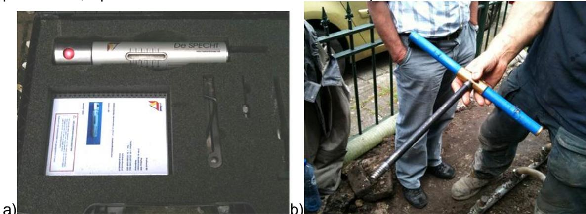
Figure 2. (a) appareil de poinçonnement (b) appareil de prélèvement
