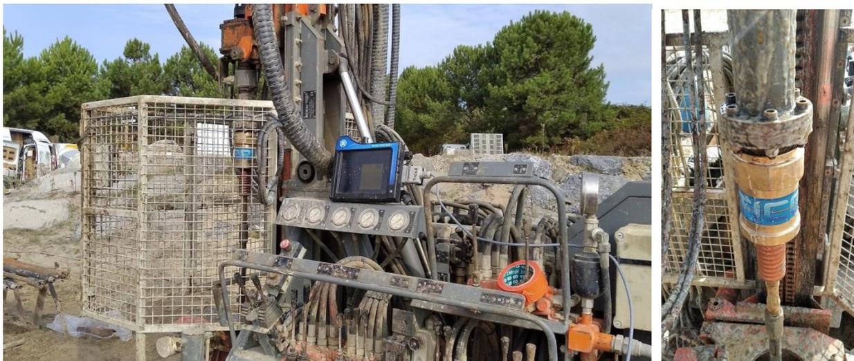
Figure 3. Capteur ASFOREC (a) installé sur une machine de forage standard utilisée pour l'étude du sol. (b) Zoom sur le capteur.
