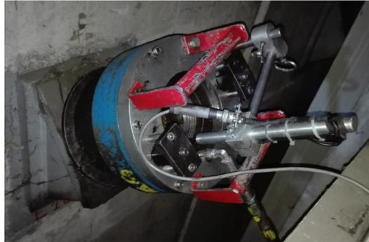
Figure 9. Matériel de pesage mis en place
